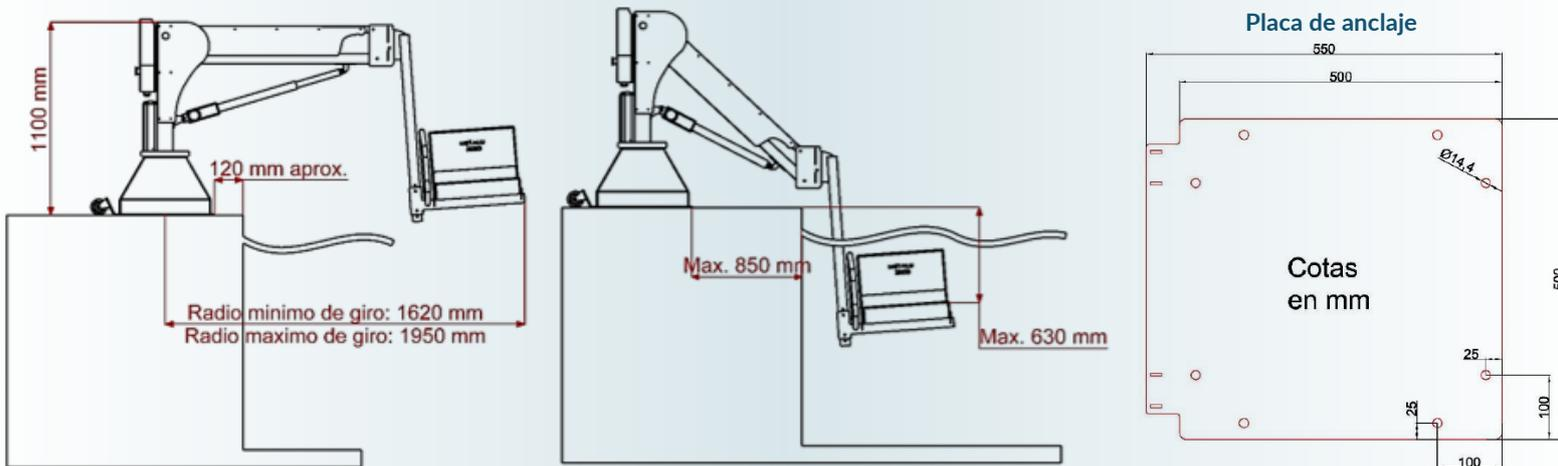
*La placa de anclaje, fabricada en inox 316, mantiene sus cotas independientemente del perfil de la piscina.*
