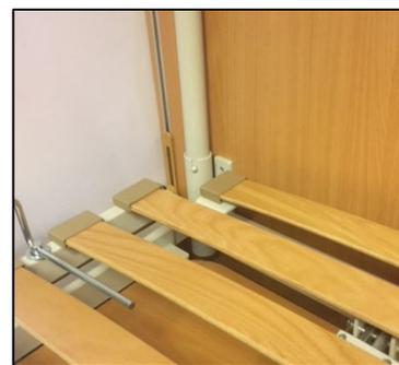
Cuando la barra de elevación no se esté utilizando, se puede subir ligeramente para liberar el pasador de posicionamiento, lo que permitirá girarla para que no moleste. Cuando esté en dicha posición, no debe soportar ningún peso.
