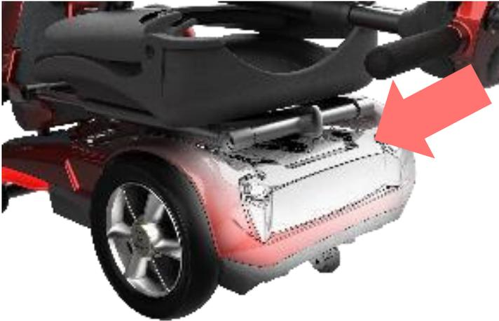
Apague el scooter y retire la llave. Coloque el interruptor de encendido/apagado (localizado junto al puerto del cargador) en posición de apagado.
