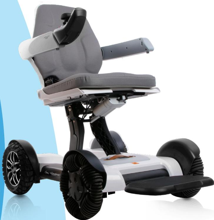
Proporciona confianza gracias al sensor giroscópico integrado, cuando el terreno es complejo y afecta a la seguridad del usuario, automáticamente se regula la velocidad
