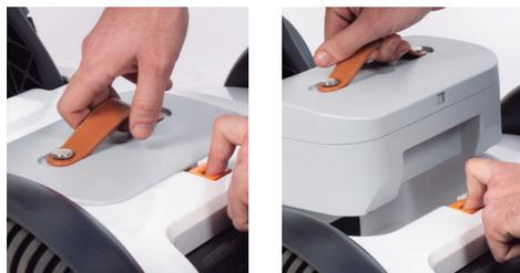
**Sustitución de la batería:** Poner la batería en el compartimiento de la batería y cerrar el cierre.
