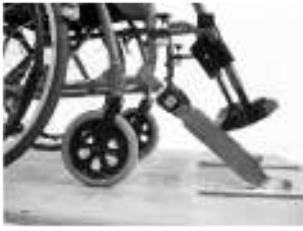
Fijando anclaje frontal
