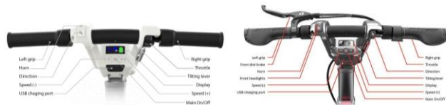
Figura 27 Descripción general de la consola de conducción
