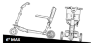
Figura 34 Ángulo de inclinación máximo recomendado
