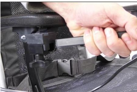
**7** ...inserte la varilla del controlador en el ajuste del reposabrazos debajo del reposabrazos.
