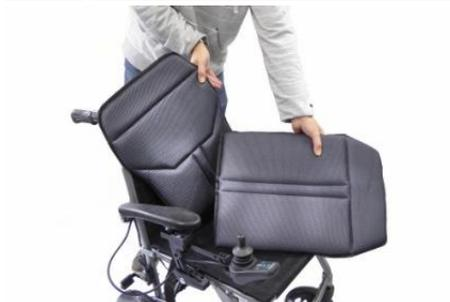
**11** Instale los cojines de los asientos como se muestra. Estos se mantienen en su lugar mediante lengüetas de velcro...
