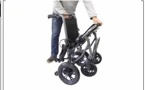
**3** Despliegue la silla eléctrica simplemente empujando la parte inferior del asiento hacia abajo.
