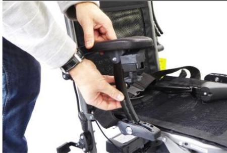
**5** Instale los soportes del reposabrazos en las ranuras y presiónelos hacia abajo hasta que se bloqueen.
