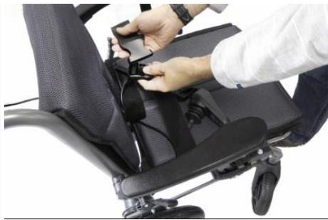
**2** Coloque el controlador y la correa del cinturón de seguridad en el asiento.
