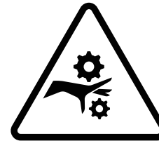
Foto 7. Peligro de aplastamiento.
