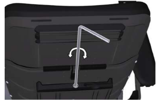
Foto 126. Utilice la manivela de ajuste suministrada.
