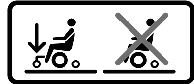
Foto 6. Las ruedas de apoyo siempre deben estar instaladas al conducir.
