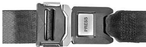
Foto 143. Hebilla de la correa bloqueada correctamente en el cierre rápido.
