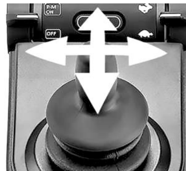
Foto 63. Con el uso de Bluetooth®, el joystick puede controlar las funciones del ratón.
