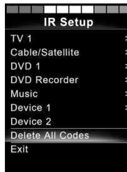
Foto 78. Elimine todos los códigos del menú Configuración IR.
