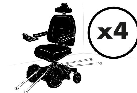
Foto 157. La silla de ruedas tiene cuatro puntos de amarre. La silla de ruedas y la posición amarre de esta imagen son genéricas.
