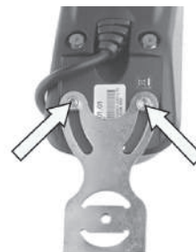
Foto 136. Retire solo uno de los tornillos.
