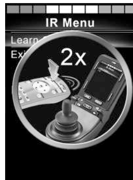
Foto 70. Apunte el control remoto hacia el receptor IR. Pulse el botón dos veces.
