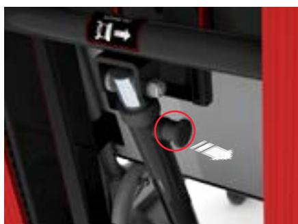
FIGURA 19 - POMO DE DESBLOQUEO PARA DESPLIEGUE ORUGA
