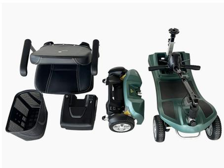
Fabricado en aluminio, Luma es un scooter superligero y a la vez robusto soportando hasta 110Kg. Se desmonta sin herramientas en unos instantes, y la parte más pesada de tan solo 9 Kg para poderlo transportar cómodamente incluso en maleteros pequeños.
