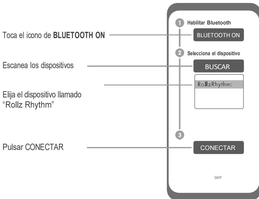
Cuando el módulo esté conectado con éxito, la aplicación Rollz mostrará el “símbolo conectado” en la esquina superior derecha. Al mismo tiempo, los LED de todas las señales activas parpadearán en el módulo.
