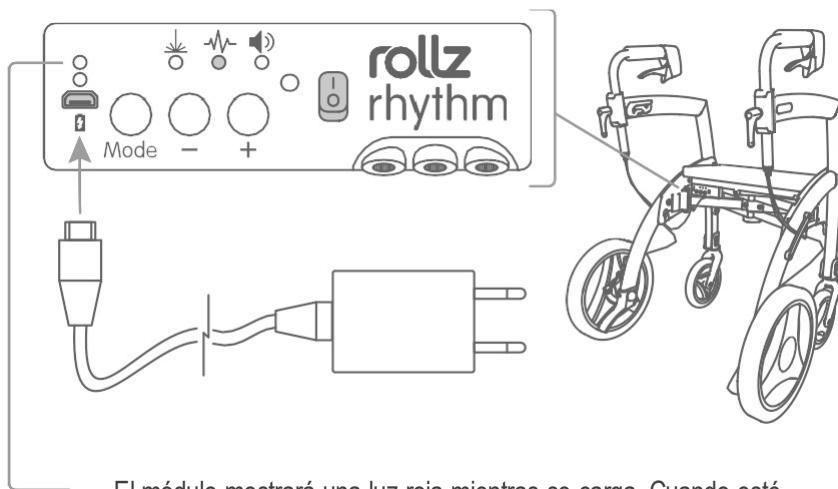
El módulo mostrará una luz roja mientras se carga. Cuando esté completamente cargado, esta luz se volverá verde. No cargue el módulo con un adaptador que exceda los 5V y 1A.
