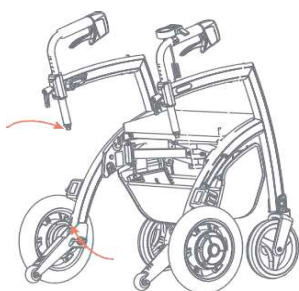
Figura 70: Ajuste del freno a través de los tornillos de ajuste en la parte superior e inferior del cable del freno.
