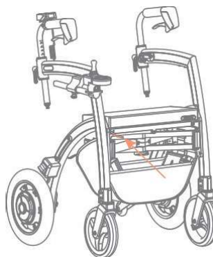
Figura 14: Empuje la palanca roja mientras levanta el asiento.
