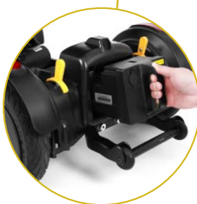
Batería de litio extraíble. Motor de 220 W x 2 uds. (Sin escobillas)
