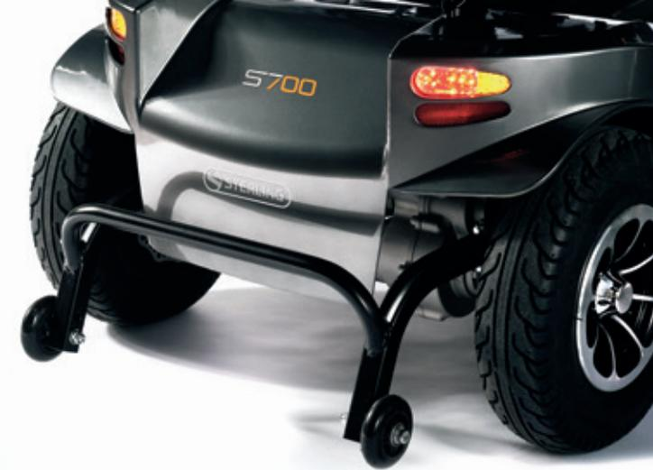
→ **Ruedas antivuelco activas de serie** para garantizar tu seguridad en pendientes. Trabajan conjuntamente con el sistema de suspensión trasero por lo que se mantienen elevadas durante la conducción para no interferir en la superación de obstáculos.
