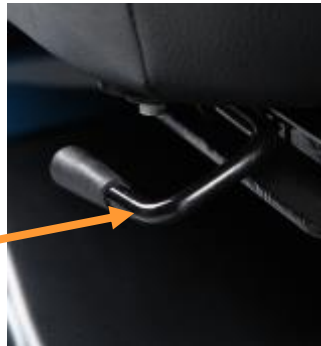
Palanca deslizamiento del asiento
