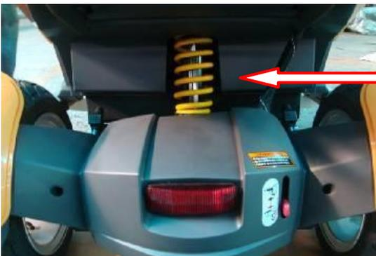
Se puede ajustar la suavidad del sistema de suspensión trasera. Hay 5 niveles de ajuste. Corresponden aproximadamente a 120kg y cada nivel puede aguantar hasta 13,5 kg.
