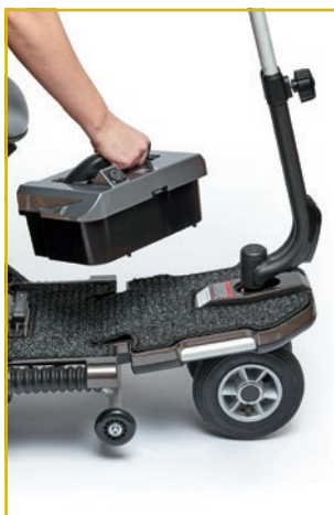
Batería de litio extraíble para facilitar su carga
