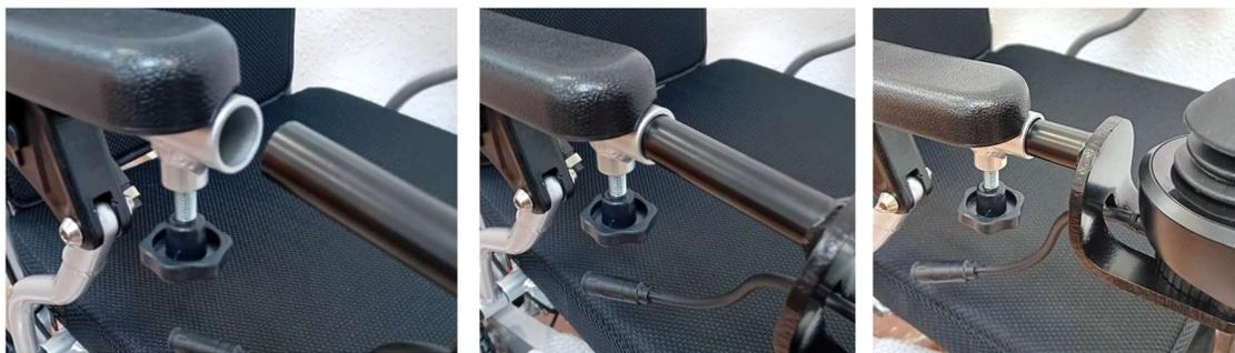
3. Como se muestra en la imagen adjunta, las dos partes del cable deberán encontrarse como en la imagen inferior.
