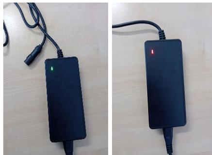
3. Después de que la luz del indicador del cargador cambie de rojo a verde, siga cargando las baterías durante 30 minutos para asegurarse de que estén cargadas por completo. Desenchufe primero el enchufe de pared y luego desenchufe el cable del panel de control (joystick).
