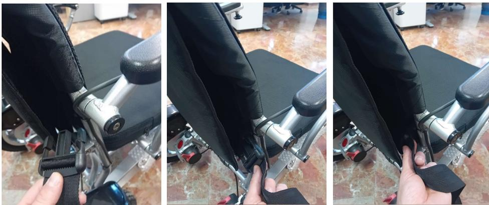
2. Coloque la cinta del cinturón de forma completa, obteniendo en cada extremo cada una de las partes de la hebilla del cinturón.
