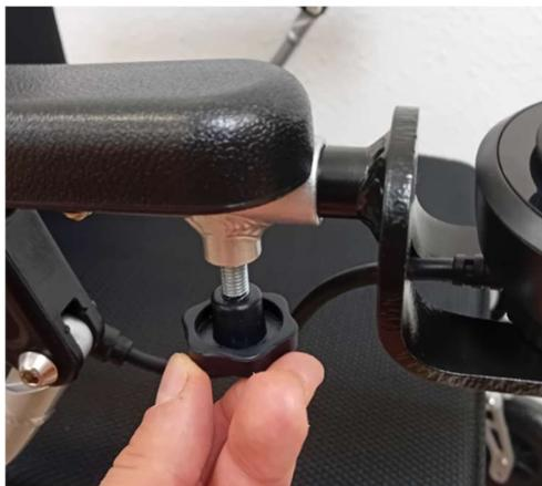
2. Inserte el joystick por la apertura del tubo de reposabrazos del lado donde desee colocar el joystick, y una vez asegure su correcta colocación, vuelva a ajustar la palometa inferior (en el sentido contrario que el punto 1).
