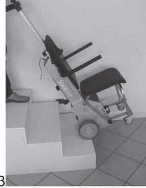
e. Si la geometría de las escaleras y la particularidad de las operaciones lo permiten, se recomienda aumentar la estabilidad del subescaleras aprovechando el peso del cuerpo, subiendo y bajando las escaleras con la máquina apoyada sobre la pierna. Este procedimiento aumenta la estabilidad y la seguridad del desplazamiento y el confort del transportado.
