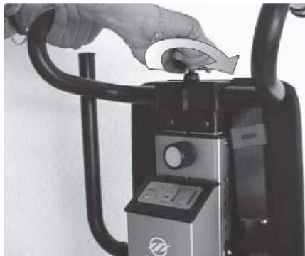
e) Introducir el paquete baterías y apretar el pomo respetando la secuencia de la figura siguiente
