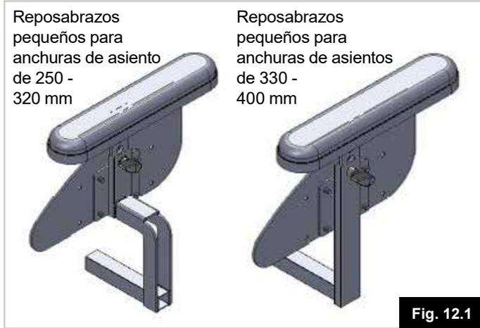
Introduzca el tubo de conexión cuadrado del reposabrazos en el soporte-guía de la base del asiento y ajuste hasta alcanzar la anchura de asiento deseada (Fig. 12.1). Sujete con 2 contratuercas y dos tornillos hexagonales (Fig. 12.2).
