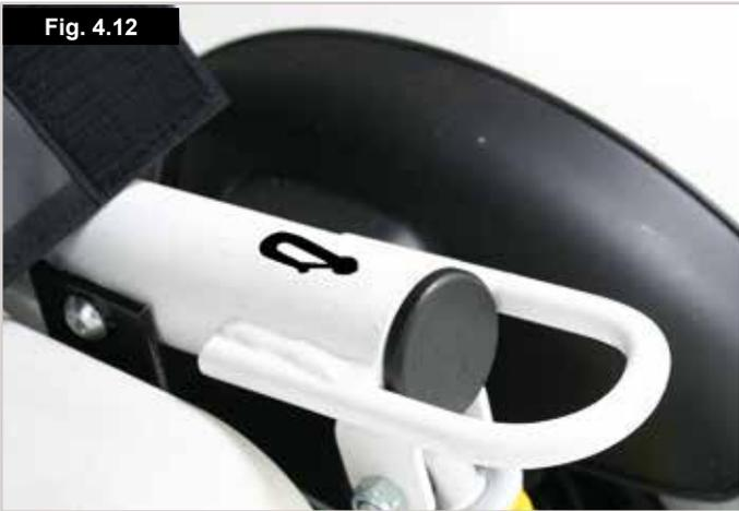
Ubicación de la etiqueta de la correa de sujeción trasera y anclaje (Fig. 4.12).
