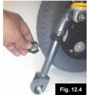
Nunca utilice la silla de ruedas sin las ruedas antivuelco instaladas. Utilice el ajuste de altura para evitar posibles interferencias con obstáculos.
