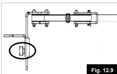
Afloje el pomo de ajuste del soporte del mando (Fig. 12.8). Coloque el mando a la altura deseada y vuelva a ajustar el pomo; procure asegurarlo para impedir que se mueva durante el uso (Fig. 12.9).
