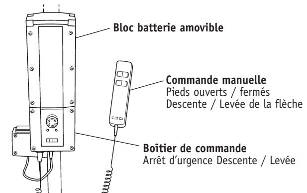
Lorsque le bloc d'alimentation doit être rechargé, retirez-le du lève-personne et branchez-le sur le chargeur autonome.
