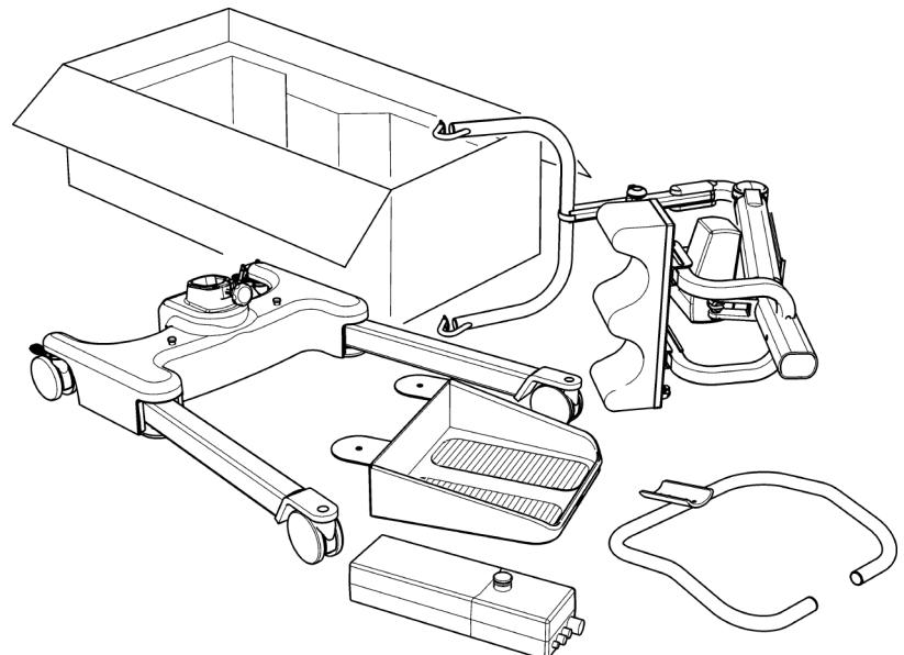
1. Stellen Sie den Rahmen an einer freien Stelle auf, und verriegeln Sie die hinteren Feststellbremsen. Befestigen Sie das Fußtablett an die Basis, indem Sie die Positionierungslöcher auf dem Gussteil der Basis benutzen.
