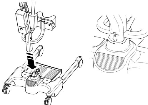
3. Ziehen Sie den Mast mit dem Mast-Feststellknopf fest, der sich vorne am Rahmen befindet.
