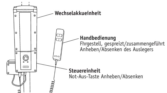
Wenn die Akkueinheit aufgeladen werden muss, wird sie vom Lifter entfernt und an eine externe Ladeeinheit angeschlossen.
