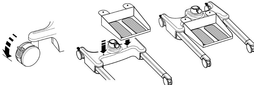
2. Stecken Sie die Mast/Ausleger-Baugruppe in die entsprechende Buchse des Rahmens.
