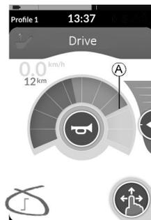
En este modo, una petición de impulso simple (hacia delante o hacia atrás) hace que la velocidad de la silla de ruedas se acelere hasta la velocidad de conducción máxima **A** de la tarjeta de función seleccionada y, a continuación, se mantiene durante el Límite de tiempo de conducción acoplada programado siempre que no se aplique otra petición.
