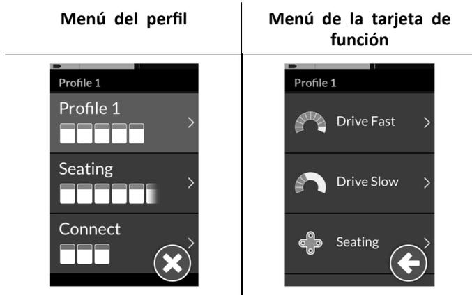
Para desplazarse por los menús con la selección de menús, elija un perfil en el menú del perfil y, a continuación, seleccione una tarjeta de función en el menú de la tarjeta de función. Antes de realizar una selección, puede desplazarse dentro y entre los menús (del perfil a la tarjeta de función y viceversa) si es necesario.
