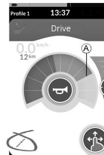
En este modo, no tiene intervalos fijos y puede elegir la velocidad acoplada usted mismo y mantener dicha velocidad durante el Límite de tiempo de conducción acoplada programado siempre que no aplique otra petición.
