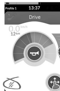
Su proveedor puede asignar cada función de conducción a un modo de conducción acoplada. Existen seis modos de conducción acoplada, que se indican en la parte inferior izquierda de la tarjeta de conducción con los símbolos que se muestran en la tabla siguiente.
