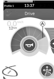
En este modo, puede elegir entre una de las tres velocidades fijas. Las velocidades disponibles son el 33 %, 67 % y 100 % de la velocidad hacia delante o hacia atrás máxima preestablecida **A** de la tarjeta de función seleccionada y, a continuación, dicha velocidad se mantiene durante el Límite de tiempo de conducción acoplada programado siempre que no se aplique otra petición.
