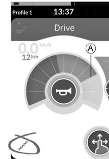
En este modo, puede elegir entre una de las cinco velocidades fijas. Las velocidades disponibles son el 20 %, 40 %, 60 %, 80 % y 100 % de la velocidad hacia delante o hacia atrás máxima preestablecida **A** de la tarjeta de función seleccionada y, a continuación, dicha velocidad se mantiene durante el Límite de tiempo de conducción acoplada programado siempre que no se aplique otra petición.
