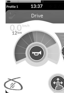
En este modo, puede aumentar o reducir entre cinco velocidades fijas. Las velocidades disponibles son el 20 %, 40 %, 60 %, 80 % y 100 % de la velocidad hacia delante o hacia atrás máxima preestablecida  $\text{A}$  de la tarjeta de función seleccionada y, a continuación, dicha velocidad se mantiene durante el Límite de tiempo de conducción acoplada programado siempre que no se aplique otra petición.
