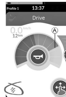
En este modo, puede aumentar o reducir entre tres velocidades fijas. Las velocidades disponibles son el 33 %, 67 % y 100 % de la velocidad hacia delante o hacia atrás máxima preestablecida (A) de la tarjeta de función seleccionada y, a continuación, dicha velocidad se mantiene durante el Límite de tiempo de conducción acoplada programado siempre que no se aplique otra petición.
