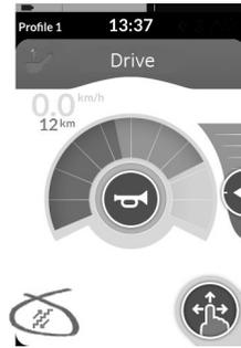
En este modo, puede aumentar o reducir entre cinco velocidades fijas. Las velocidades disponibles son el 20 %, 40 %, 60 %, 80 % y 100 % de la velocidad hacia delante o hacia atrás máxima preestablecida  $\text{\textcircled{A}}$  de la tarjeta de función seleccionada y, a continuación, dicha velocidad se mantiene durante el Límite de tiempo de conducción acoplada programado siempre que no se aplique otra petición.
