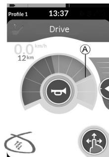
En este modo, puede aumentar o reducir entre tres velocidades fijas. Las velocidades disponibles son el 33 %, 67 % y 100 % de la velocidad hacia delante o hacia atrás máxima preestablecida **A** de la tarjeta de función seleccionada y, a continuación, dicha velocidad se mantiene durante el Límite de tiempo de conducción acoplada programado siempre que no se aplique otra petición.
