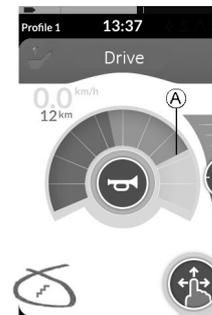
En este modo, puede elegir entre una de las tres velocidades fijas. Las velocidades disponibles son el 33 %, 67 % y 100 % de la velocidad hacia delante o hacia atrás máxima preestablecida **A** de la tarjeta de función seleccionada y, a continuación, dicha velocidad se mantiene durante el Límite de tiempo de conducción acoplada programado siempre que no se aplique otra petición.
