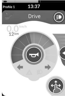
Se enciende el intermitente izquierdo o derecho. El testigo del intermitente izquierdo o derecho se enciende en el panel de iluminación.
