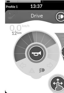
Las luces de posición se encienden. El testigo de las luces de posición se enciende en el panel de iluminación.
