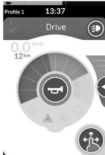
Las luces de peligro se encienden. El testigo de las luces de peligro se enciende en el panel de iluminación.
