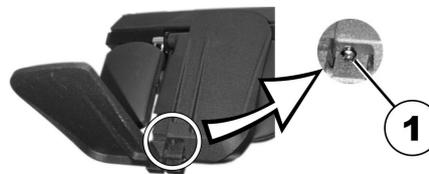
1. Pliegue hacia arriba las paletas del reposapiés para poder acceder a los tornillos de ajuste (1).
