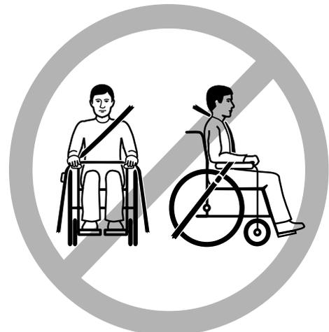
**i** Colocación incorrecta del cinturón de seguridad
