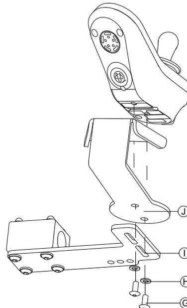
Fije el mando y el soporte ⑩ al bastidor ⑩ con tornillos ⑧ y arandelas ⑨.
