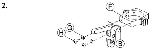
2. Fije la pinza **F** al adaptador de DLX-CR400 **B** con las arandelas **G** y los tornillos **H**.
