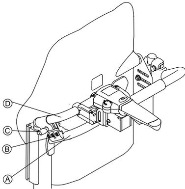
1. Fije la abrazadera de sujeción (B) en la empuñadura (A) de la silla de ruedas.
