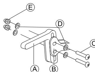
Monte el soporte del joystick Ⓐ en el adaptador del mando Ⓑ con los tornillos Ⓒ, las arandelas Ⓓ y las tuercas Ⓔ.
