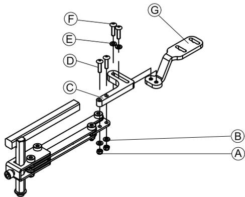
1. Introduzca los tornillos ④ a través del bastidor ③, el soporte del mando y las arandelas ②.
