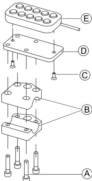
El interruptor de 10 ajustes se instala en la parte posterior de la silla de ruedas mediante un bastidor ② en la empuñadura o la barra de empuje.
