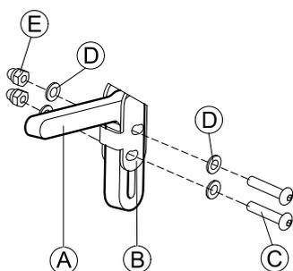
Monte el soporte del joystick **A** en el adaptador del mando **B** con los tornillos **C**, las arandelas **D** y las tuercas **E**.
