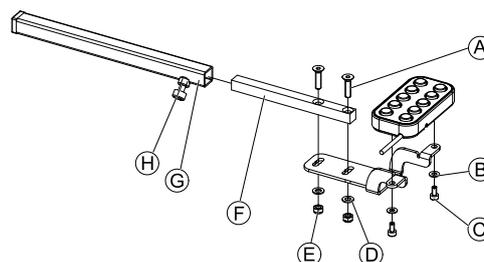
1. Fije el interruptor de 10 ajustes al bastidor mediante los tornillos **C** y las arandelas **B**.
