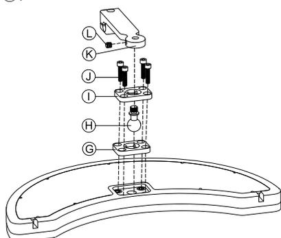
Inserte la placa de pinza **G** en el hueco de la bandeja Eclipse Tray.
