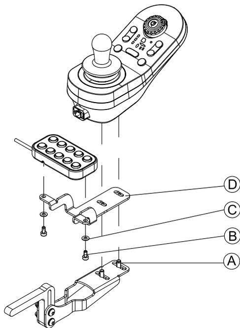
1. Fije el interruptor de 10 ajustes al bastidor ④ mediante los tornillos ② y las arandelas ③.
