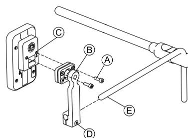
1. Monte el mando C en el bastidor B con tornillos A.
