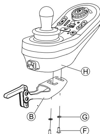
Monte el mando Ⓗ en el adaptador Ⓑ con tornillos Ⓕ y arandelas Ⓖ.
