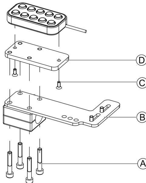
1. Fije el interruptor de 10 ajustes a la placa de montaje ④ mediante los tornillos ③.
