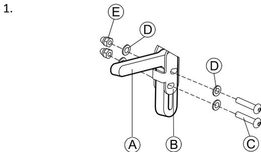
1. Monte el soporte del joystick **A** en el adaptador de DLX-CR400 **B** con los tornillos **C**, las arandelas **D** y las tuercas **E**.
