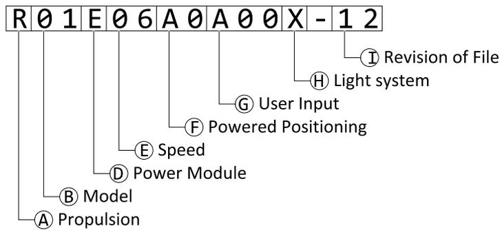
Fig. 12-1 Ejemplo del nombre de un programa de Kite (motor de dos cilindros solo para conducción) con la nomenclatura válida hasta julio de 2018
