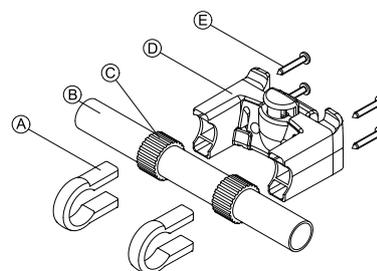
1. Coloque las abrazaderas de sujeción A en la empuñadura B de la silla de ruedas.
