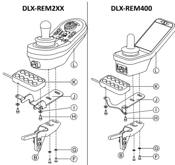
Monte el mando **L** en el adaptador del mando **B** y la hoja de soporte **J** con los tornillos **F** y las arandelas **G**.
