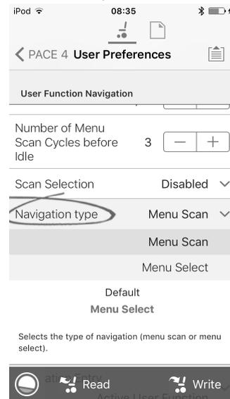
Ajuste **Navigation type** (Tipo de navegación) en **Menu Scan** (Exploración de menús).
