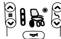
2. Presione las teclas de selección de la función de conducción **A** o **B** hasta que se encienda la función de conducción que desea.
