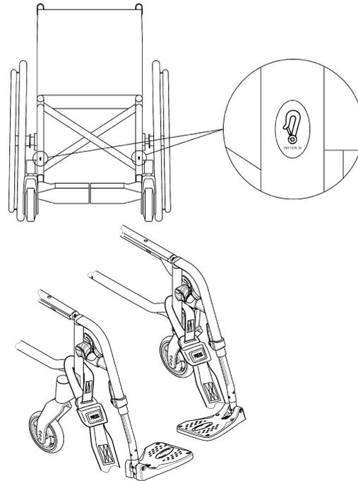
1. Fije las correas delanteras por encima de los soportes de la rueda, tal y como se muestra en la figura anterior (consulte la ubicación de las etiquetas de fijación).
