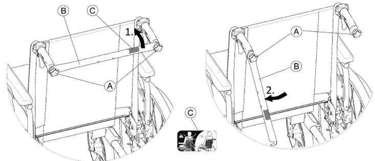
1. Afloje ligeramente los dos tornillos manuales (A), tire hacia arriba del refuerzo para la espalda (B) y gírelo hacia abajo a lo largo del respaldo.
