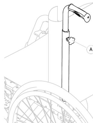
1. Para ajustar la altura de las empuñaduras, afloje el pomo (A), empuje la empuñadura hasta la posición que desee y vuelva a apretar el pomo.
