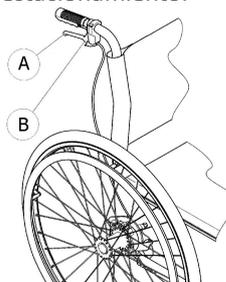
1. Para frenar, apriete la palanca del freno (A) situada en la empuñadura.
