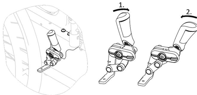
1. Para accionar el freno, empuje la palanca del freno hacia delante con la palma de la mano tanto como sea posible.
