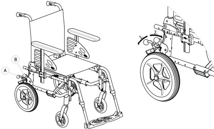
1. Para accionar el freno, empuje la palanca del freno (A) hacia abajo tanto como sea posible.
