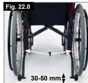
Al pulsar el botón de desmontaje (1), las ruedas anti-vuelco pueden colocarse hacia arriba o, directamente, extraerse. Se deberá mantener un espacio de 30 a 50 mm entre los anti-vuelcos y el suelo.
