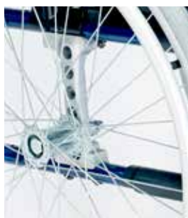
Pletina trasera del eje de aluminio
