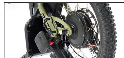
Puntera derecha desmontable para un fácil cambio de cámara y/o neumático.
