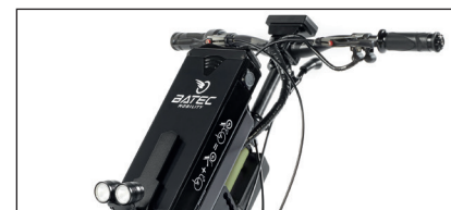
Autonomía de 50 km con la batería de 48 V - 678 Wh. Autonomía de 22 Km con la batería de 36/48v - 280 Wh.
