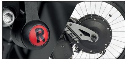
Motor de alta potencia Brushless de 250 RPM 900W con marcha atrás. Velocidad máxima 20 Km/h.
