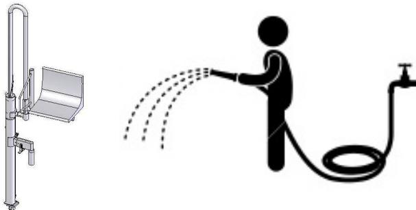
Tengan presente que aunque METALU B-2 está fabricado con acero inoxidable AISI 316, sobre la superficie del elevador caen salpicaduras de agua con cloro, polvo y todo tipo de impurezas, si estas partículas no se limpian, con el tiempo se incrustan en el acero dejando un mal aspecto. Para evitarlo basta con que **cada día** al regar la piscina pase la manguera de agua dulce con presión por el elevador, así conseguirá que todas estas partículas resbalen y no lleguen a incrustarse en el acero.
