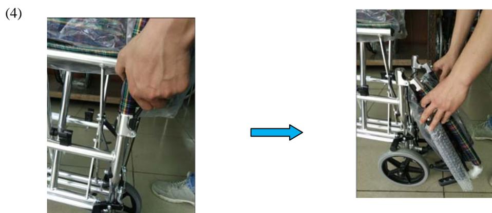
Para desplegarla, sujetar la manilla de empuje, apretar a continuación la empuñadura hacia delante hasta escuchar que la barra metálica queda sujeta. Bajar a continuación el reposabrazos y desplegar el reposapiés.
