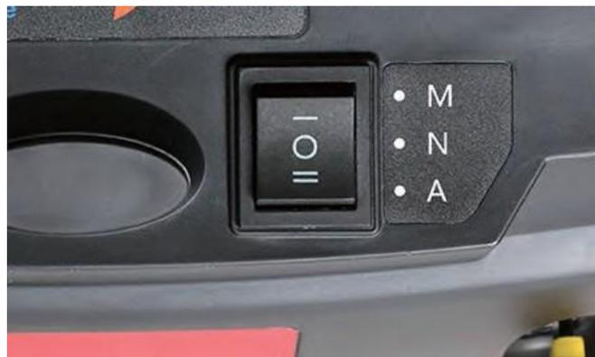
**Atención: Mientras utilice la silla, ponga el selector en N, para impedir que alguien pueda hacer uso del dispositivo de plegado manual y por control remoto mientras usted está conduciendo la silla de ruedas.**
