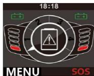
1, Si el indicador de batería está en rojo, cargarla lo antes posible, reducir el uso de la función de conducción y cambiar a modelo empujar la silla de ruedas. De no hacerlo, se podría ver atrapado en un lugar poco seguro, como en medio de una carretera.
