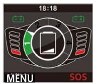
2, Cuando la potencia es menor del 10%, el indicador de batería está rojo e indica que no se puede avanzar, la potencia es demasiado baja y la silla se parará automáticamente en pocos minutos.
