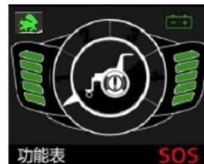
Fallo del motor en el lado izquierdo: No se establece conexión con el accionamiento de la rueda izquierda. El motor del lado izquierdo está estropeado.
