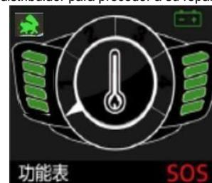
Sobrecalentamiento: La temperatura interna del eje impulsor o del regulador es demasiado alta, lo que puede provocar un fallo y que la silla de ruedas no funcione correctamente.
