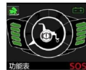
Fallo del motor en el lado derecho: No se establece conexión con el accionamiento de la rueda derecha. El motor del lado derecho está estropeado.
