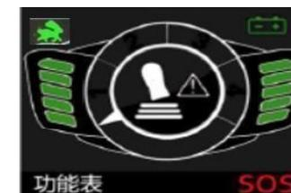
Fallo de la palanca de control: El icono del centro muestra un fallo en la palanca de control.
