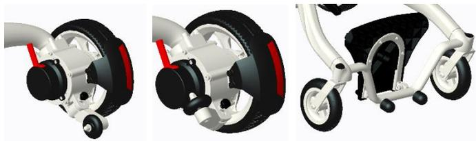
Paso 2: tire del cable de desplegado para soltar los pasadores elásticos de los orificios de bloqueo en ambos lados y empuje el respaldo hacia adelante.
