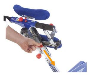
1.- Con la oruga apagada (llave en OFF), tire hacia debajo de la palanca roja de la parte derecha del manillar para desbloquearlo.
