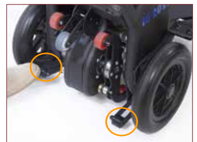
Pedales para elevar las ruedas de bloqueo y desplazar más fácilmente la silla en superficies planas.
