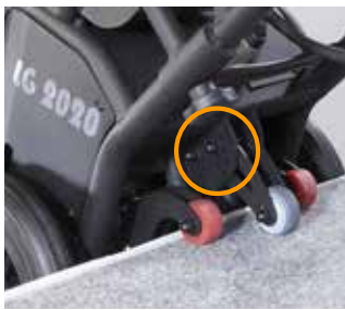
Sistema de brazos rotacional, con soporte de rueda ajustable en función de las diferentes alturas de escalón para aumentar la estabilidad y seguridad.
