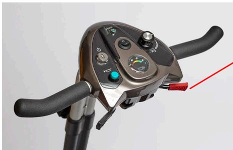
Control palanca de dedo/Fuerza máx. Aplicada en la palanca
